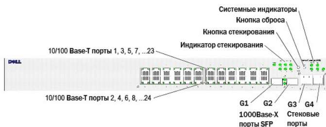
Рис 2-1. Передняя панель устройства PowerConnect 3524
